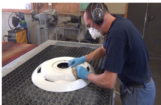
Photo 3 Ponçage d'un enjoliveur de bus sur une table aspirante
