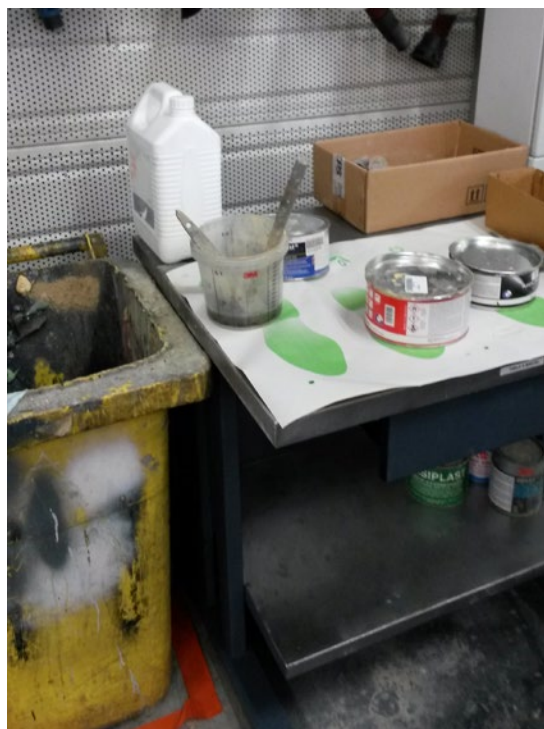
Photo 6 Préparation de mastic sans captage
